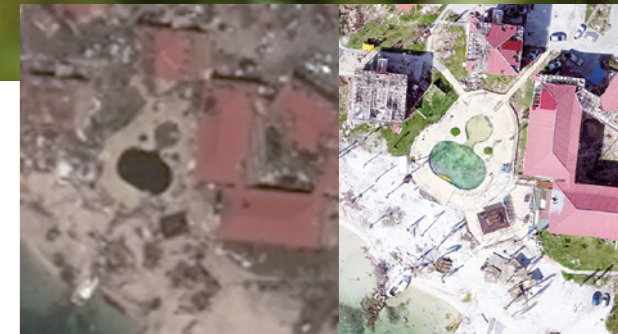
Différence de qualité entre une image du satellite Pléiades (à gauche, le 10-09-17) et une image prise par un drone (à droite, le 3-11-2017).
